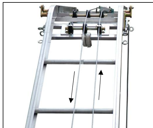
Fig. 37 kabelföring på krökställe
